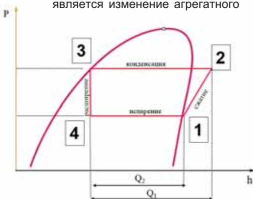
Рис. 1. Принцип цикла Карно
