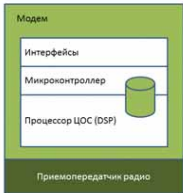
Рис. 3. Архитектура системы IoT, построенной с использованием технологии SDR
