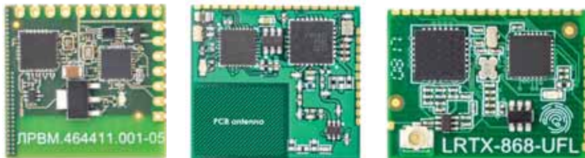
Рис. 3. LoRaWAN-радиомодули «Лартех» с прошивкой Merit0ious и поддержкой обновления «по воздуху»
