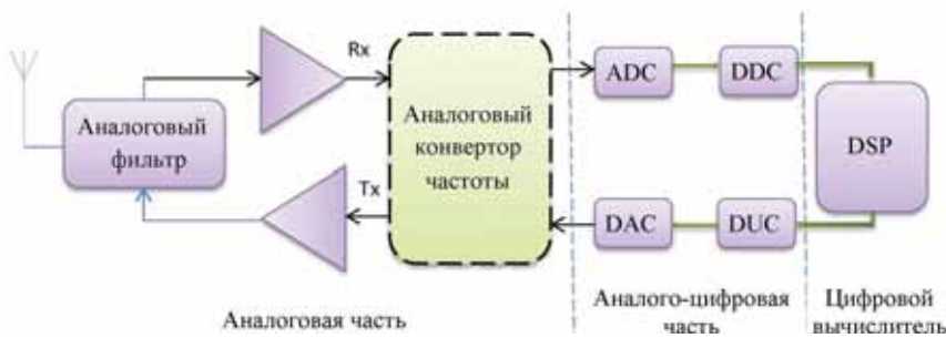
Рис. 3. Функциональная схема аппаратной части оборудования с цифровой обработкой сигналов
