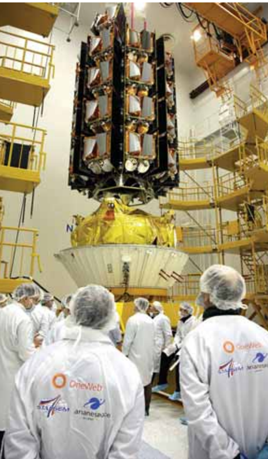
34 спутника OneWeb собраны в пакет для запуска с помощью российской ракеты-носителя «Союз»
