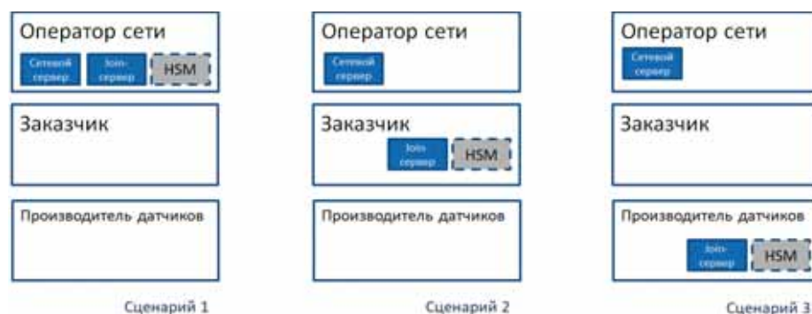
Рис. 8. Возможные сценарии размещения Join-сервера
