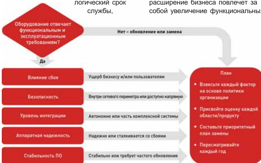
Рис. 2. Составление плана обновления сетевого оборудования
