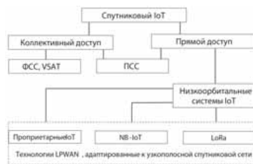
РИС. 1. Классификация спутникового IoT по функциональным и техническим признакам сети (ПСС – системы Iridium, Globalstar, Inmarsat и т. п.; ФСС – системы на основе геостационарных спутников фиксированной спутниковой службы)
