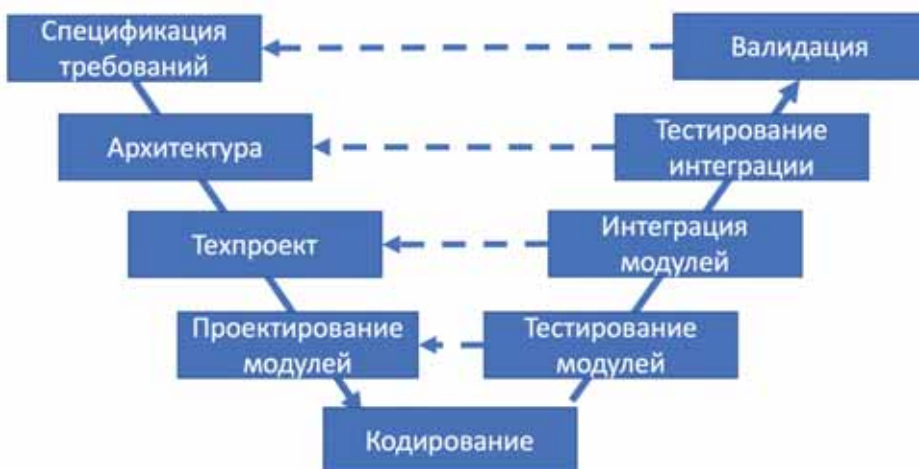
Рис. 6. Каноническая V-модель разработки
